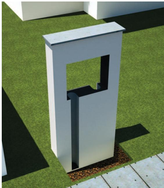
**01** Preparar o muro, ou construir uma mureta para instalar a caixa padrão e os tubos camisa de 50 mm/PVC.
