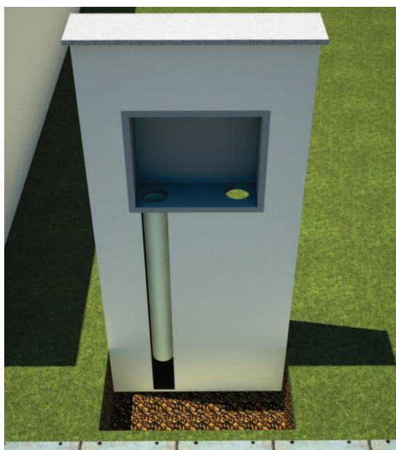
**03** Instale o tubo camisa na maior abertura da base da caixa, de acordo com sua necessidade. Ele deve sempre ficar embutido em alvenaria.
